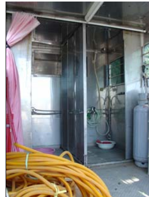
写真9 シャワー車の外観とその内部 (シャワー2つと給湯ボイラー設備が整っている。)
